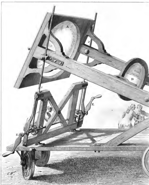
DESSEIN en Perspective d'une Grande Loupe formée par 2 Glaces de 52 po. de diam. chacune de 16' pieds de diam. par M r de Berniere, Contrôleur des Ponts et Chaussées, et ensuite rempli d'esprit de vin il a quatre pieds de diam. et plus de 6 pouce. d'épaisseur au centre: C par les soins de Monsieur DE TRUDAINE, Honoraire de cette Académie, sous les yeux de Messrs L. La Monture a été construite d'après les idées de M r de Berniere, perfectionnée et exécutée par M r C
